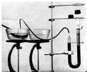
Модель теплового двигателя,
