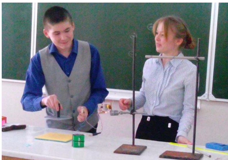
Рис. 2. Исследование электрофора посредством светодиодного индикатора знака заряда, выполняемое совместно с заинтересованным школьником
