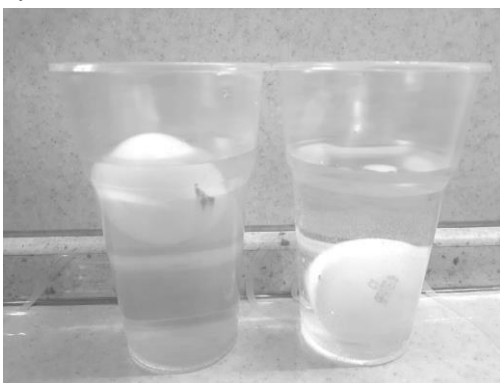
Рис. 4. Яйцо как ареометр
